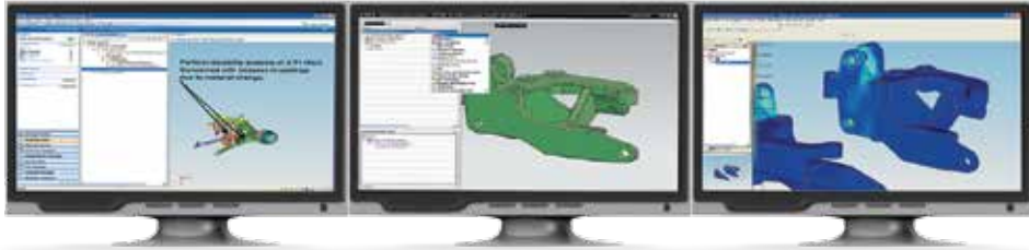
1. シミュレーション・タスクがTeamcenter内に割り振られ、管理される 2. CAEモデルがNXによって作成され、シミュレーションが実行される 3. シミュレーション結果がTeamcenter Lifecycle Visualizationを使って可視化され、検証される
